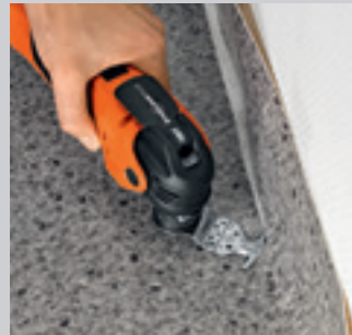
Maton, PVC-lattian, pahvin, bitumipaanojen ja kattopahvin leikkaamiseen. Kolme leikkuupintaa.
