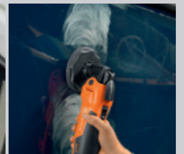
Naarmujen poistaminen ajoneuvojen maalipinnoista huopakiihottustyynillä ja kiillotusaineella.
