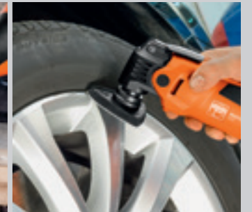
Erittäin hienorakeiset erikoispaperit soveltuvat täydellisesti maalivirheiden ja virhekohtien korjaamiseen.
